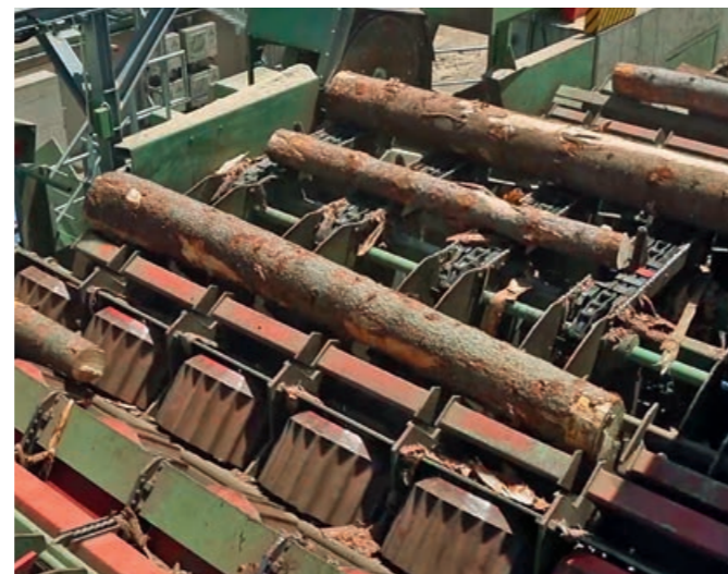
Beschickung mittels chainless Stufenschieber mit Stammausrichtung und Anschnittfräse. Beschleunigung über V-Rollengang logrunner.
