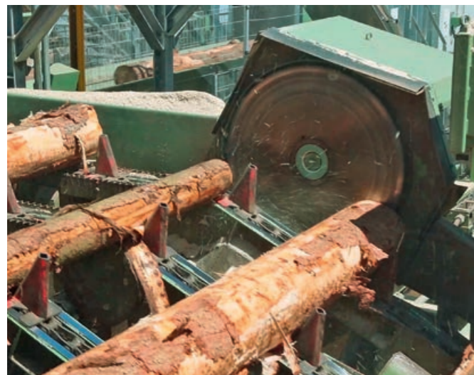
Eine Frässhleibe sorgt für eine saubere Stirnfläche zur besseren Beurteilung.
