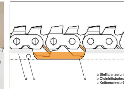
Patentiertes STIHL - Ketten schmiersystem für lange Lebensdauer
