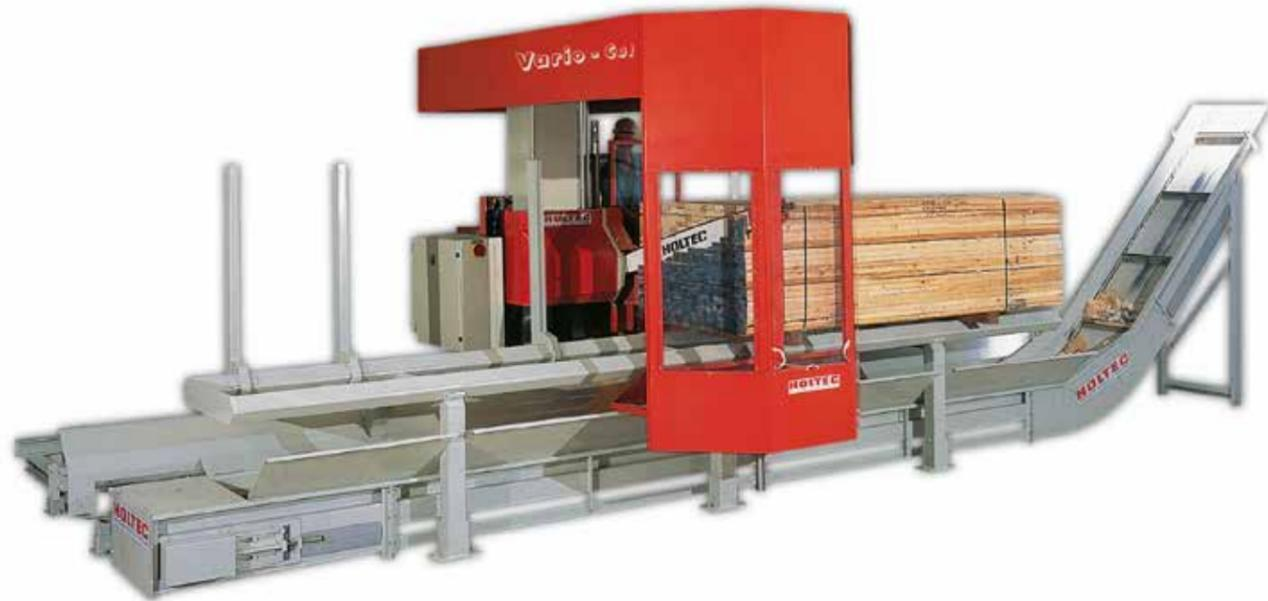
**Paketkappsäge VarioCut als positionierbares Kappaggregat**
