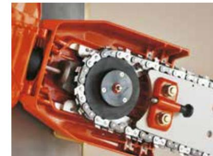
Werkzeugloser, schneller Kettenwechsel
