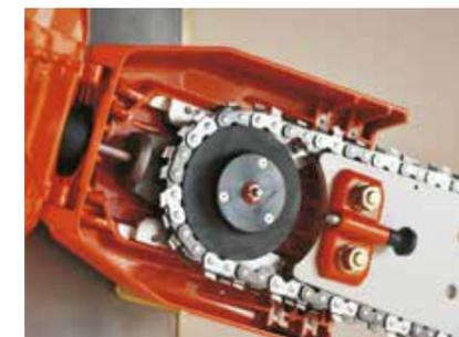
Werkzeugloser, schneller Kettenwechsel
