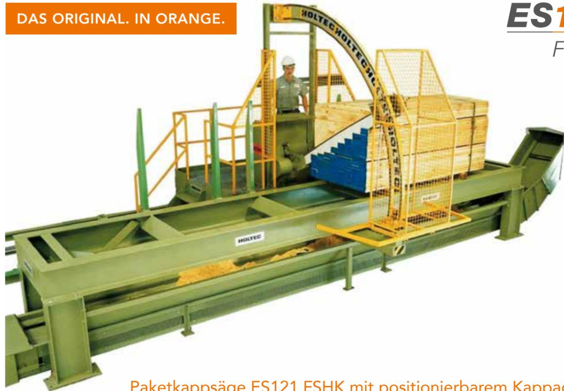
**Paketkappsäge ES121 FSHK mit positionierbarem Kappaggregat**
