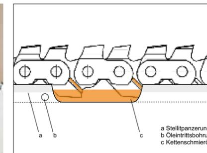
Patentiertes STIHL - Kettenschmiersystem für lange Lebensdauer
