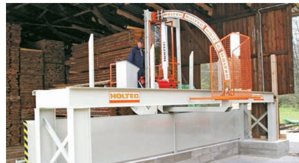
Piccolo-FSHK: Manuelle Positionierung der Sägeeinheit und manuelles Schwenken der Schnittgarnitur
