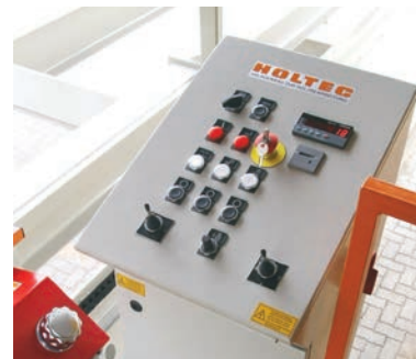
Ergonomisches Bedienpult mit Längenanzeige
