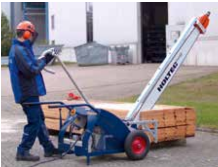
Leichte Handhabung und geringer Kraftbedarf beim Schneiden. Luftbereifung und dreifach Anlagestützen garantieren einen exakten Stand und einen winkligen Schnitt – unter fast allen Bedingungen.
