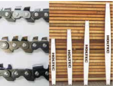
Schnittgarnitur mit rundum stellitgepanzelter Führungsschiene (Schnittlänge 100–250 cm). Lieferbar mit STIHL-Spitzzahnkette, Hartmetall-Spitzzahnkette oder Hobelzahnkette.
