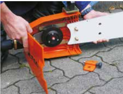
Einfacher Kettenwechsel ohne zusätzliche Werkzeuge.
