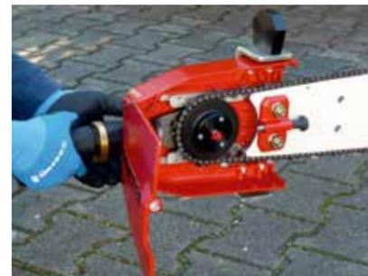
Einfacher Kettenwechsel ohne zusätzliche Werkzeuge.
