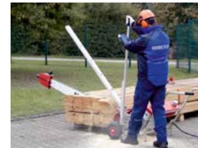
Leichte Handhabung und geringer Kraftbedarf beim Schneiden. Der dreifach Positionierwinkel garantiert einen exakten Stand und einen winkligen Schnitt. Lieferbar mit Luftbereifung oder Vollgummireifen.
