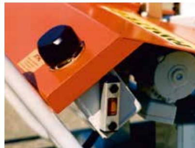
Separater Schmierölpumpenantrieb gewährleistet unter allen Bedingungen eine konstante Fördermenge. Schmierölvorrat ausreichend für ca. 4 h reine Betriebszeit.
