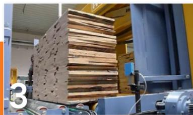
3 Abtransport der extrem kurzen Pakete über einen Rollengang mit integriertem Querförderer
