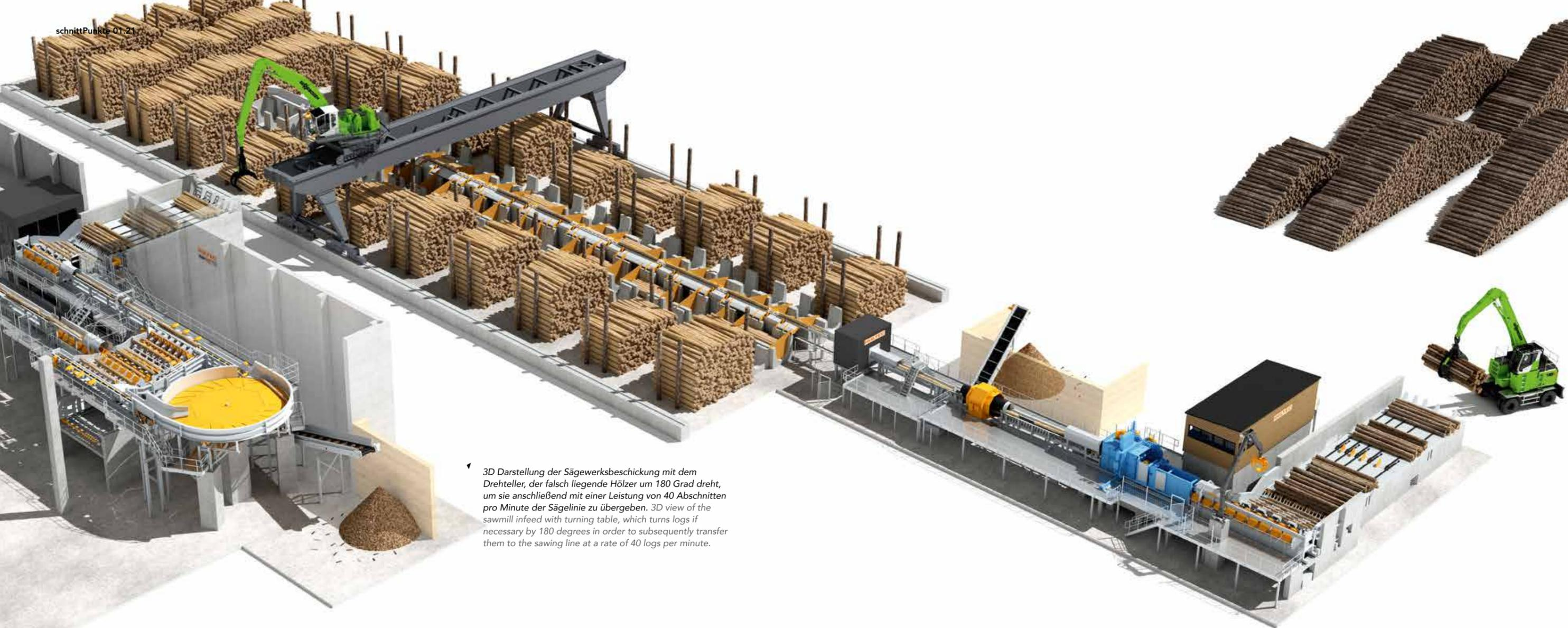
3D Darstellung der Sägewerksbeschickung mit dem Drehteller, der falsch liegende Hölzer um 180 Grad dreht, um sie anschließend mit einer Leistung von 40 Abschnitten pro Minute der Sägelinie zu übergeben. 3D view of the sawmill infeed with turning table, which turns logs if necessary by 180 degrees in order to subsequently transfer them to the sawing line at a rate of 40 logs per minute.
