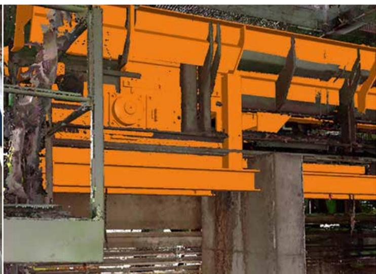
Im Rahmen der Detailkonstruktion passte Holtec die Förderanlagen exakt in das dreidimensionale Digitalmodell ein. Eine laufende Kollisionsprüfung mit Bestandskomponenten verhindert unangenehme Überraschungen.
