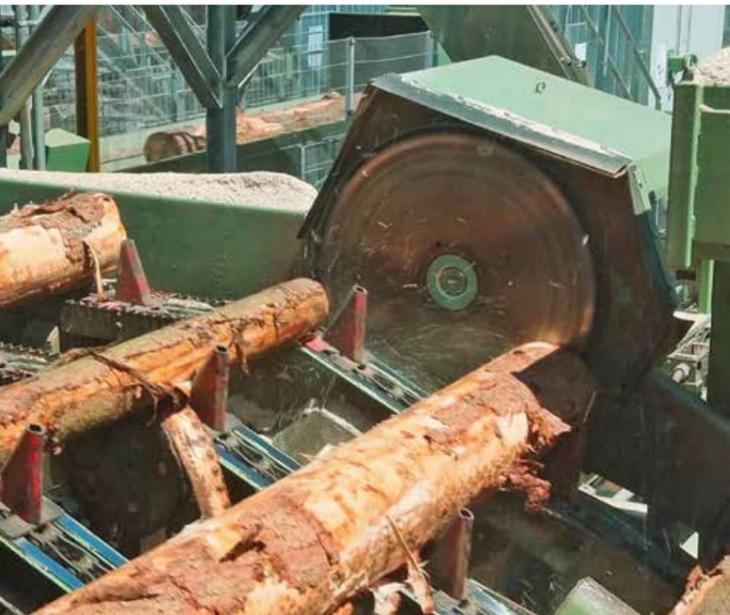
Eine Frässhleibe sorgt für eine saubere Stirnfläche zur besseren Beurteilung. Milling disc provides a clean surface for better log evaluation.
