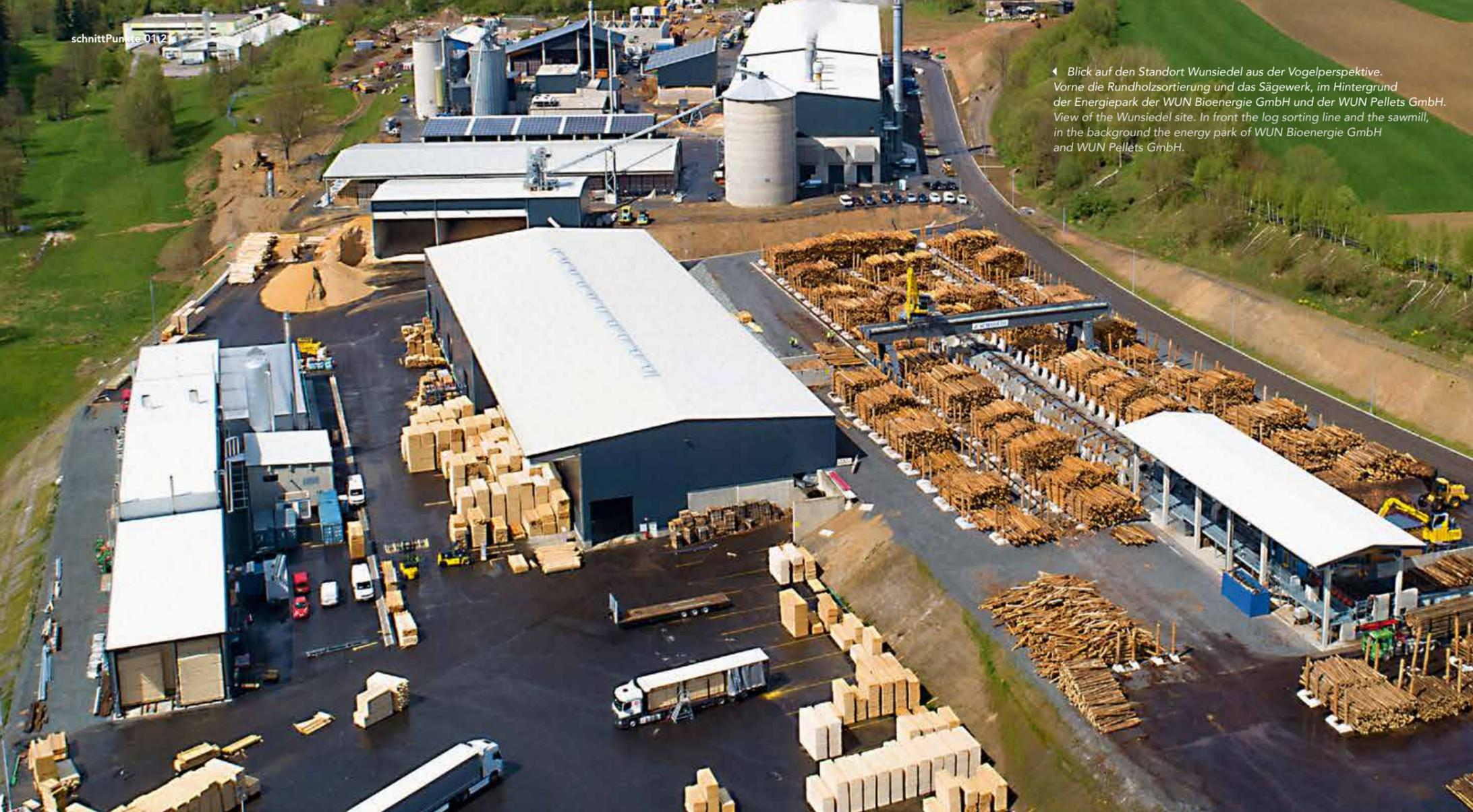
◀ Blick auf den Standort Wunsiedel aus der Vogelperspektive. Vorne die Rundholzsortierung und das Sägewerk, im Hintergrund der Energiepark der WUN Bioenergie GmbH und der WUN Pellets GmbH. View of the Wunsiedel site. In front the log sorting line and the sawmill, in the background the energy park of WUN Bioenergie GmbH and WUN Pellets GmbH.
