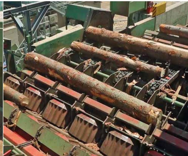
Beschickung mittels chainless Stufenschieber mit Stammausrichtung und Anschnittfräse. Beschleunigung über V-Rollengang logrunner. Log feeding by means of chainless step feeder with log alignment and milling disc. Log acceleration via V-shaped rollerway logrunner.
