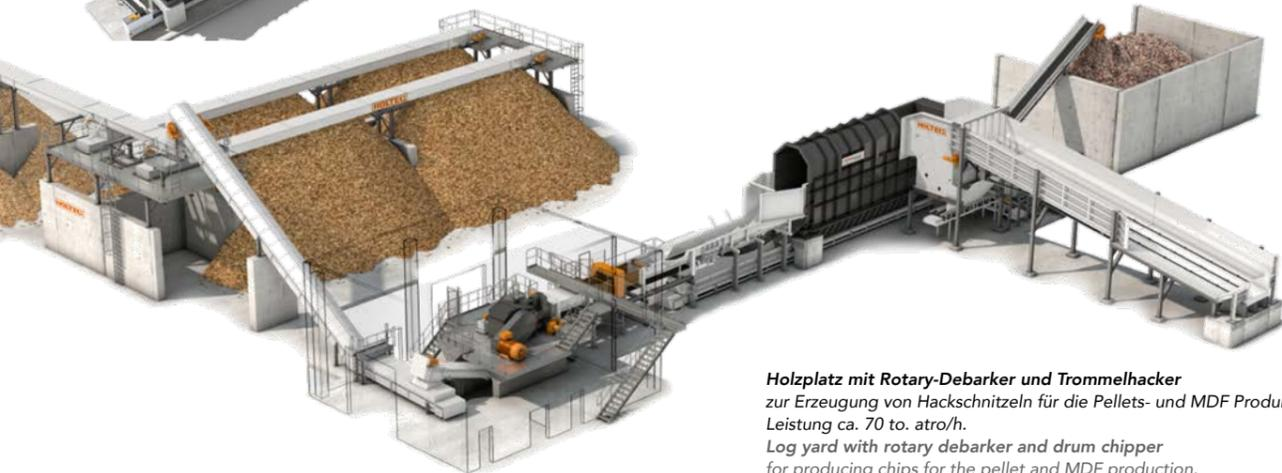
**Holzplatz mit Rotary-Debarker und Trommelhacker zur Erzeugung von Hackschnitzeln für die Pellets- und MDF Produktion.**
