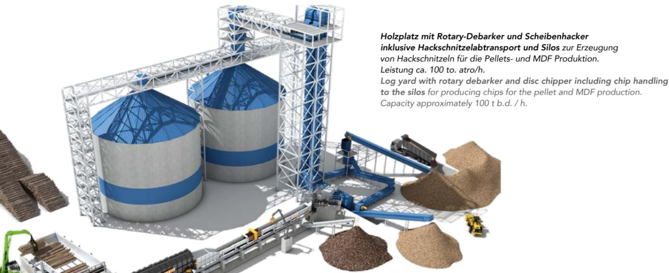
**Holzplatz mit Rotary-Debarker und Scheibenhacker inklusive Hackschnitzelabtransport und Silos zur Erzeugung von Hackschnitzeln für die Pellets- und MDF Produktion.**
