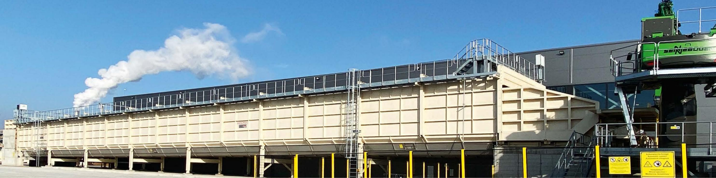
In einer 80 m langen Konditionieranlage verbringen die Kiefernstämme durchschnittlich einen Tag, ehe sie für den Schälvorgang entsprechend fertig aufbereitet wurden.
