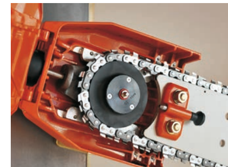
Changement rapide de la chaîne, sans outillage spécial
