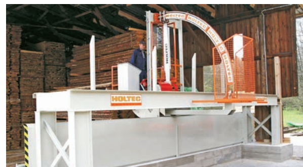
Piccolo-FSHK: Positionnement manuel du groupe de tronçonnage et pivotement manuel de l'ensemble de coupe
