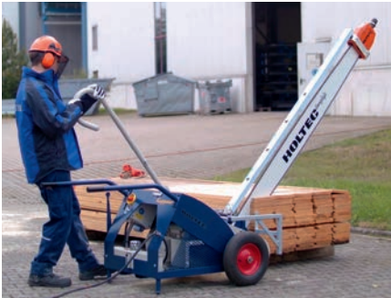
Maniement facile et effort de coupe réduit. Roues à pneus et triple butée d'alignement garantissant une position précise et une coupe à angle droits
