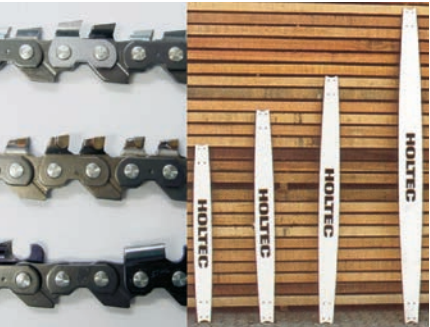
Ensemble de coupe avec guide-chaîne stellité des 2 côtés - réversible 4 fois (longueur de coupe 100 à 250 cm). Livrable avec chaîne STIHL à dents pointues, à pastilles de carbure WIDIA ou à gouges
