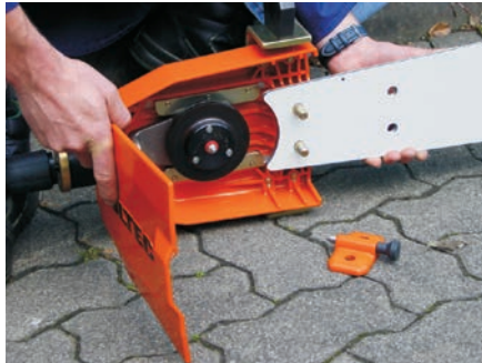
Changement rapide de la chaîne, sans aucun outillage supplémentaire
