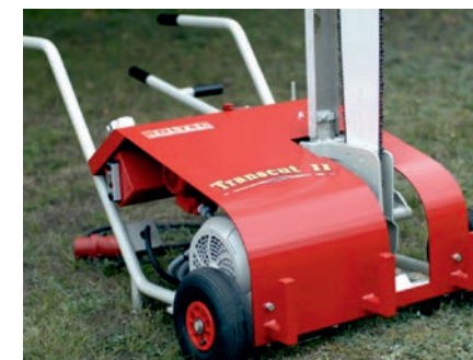
Construction légère, design moderne, adaptée pour couper des sections de 1,15 x 1,15 m
