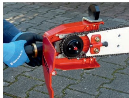
Changement rapide de la chaîne, sans aucun outillage
