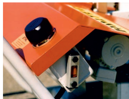
Entraînement de la pompe d'huile de graissage séparé - ce qui garantit un débit constant en toutes circonstances. Capacité du réservoir suffisante pour 4 heures de fonctionnement
