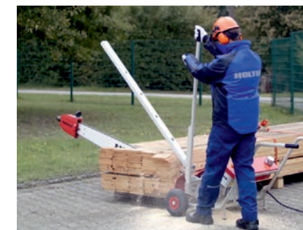
Maniement facile et effort de coupe réduit. La triple butée d'alignement garantit une position précise et une coupe à angles droits
