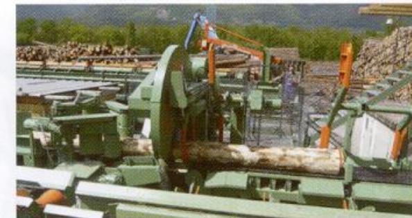
Rundholzkapline mit speziellem Beschickungs- und Anschlagssystem für eine hohe Positionier- und Zentriergenauigkeit
