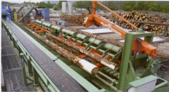
Beschickung mit integriertem Wurzelreduzierer
