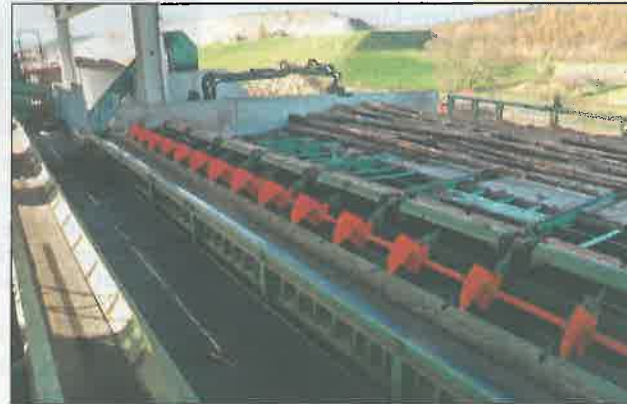
Langholzaufgabe von Holtec mit Leistenquerförderer und Scheibeneinleger zur Übergabe auf das Förderband (in Bildmitte) vor der Entrindung. Fotos: Holtec
