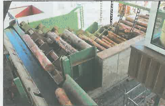
Die neue Kurzholzaufgabe: die Abschnittvereinzlung erfolgt über einen doppelwirkenden Stufenschieber.
