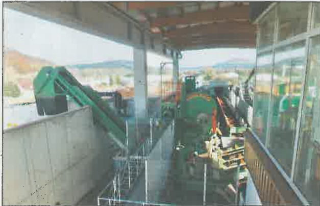
Langholzkappung in Form einer Bandkapplinie. Als Kappsäge dient eine Kreissäge mit 2 m Blattdurchmesser.
