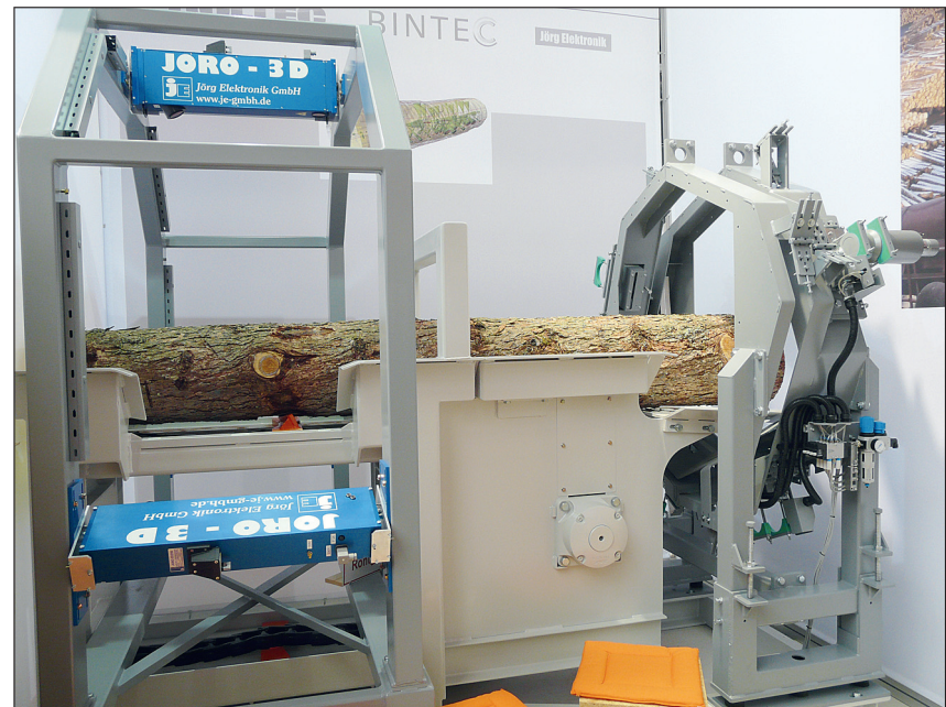
Optische Lasermessung (links) von Jörg Elektronik kombiniert mit der Bintec-Röntgentechnik (rechts), hier zur Vereinfachung nur mit einer statt der sonst vier Röntgenquellen ausgerüstet, auf Fördertechnik von Holtec. Foto: L.Pirson
