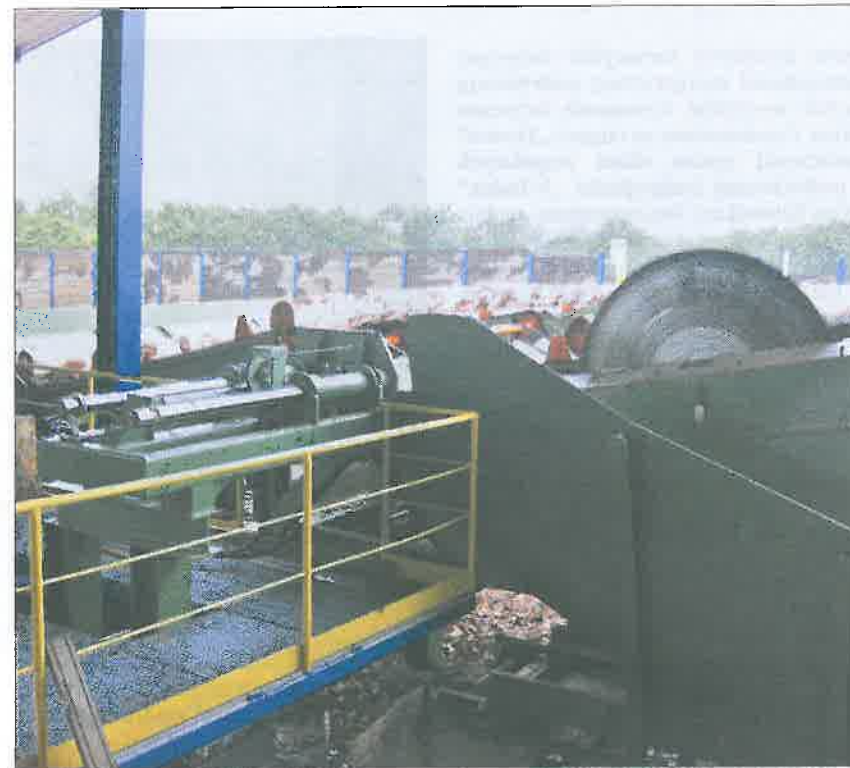
Piła przycinająca przed podwójną linią kapującą
