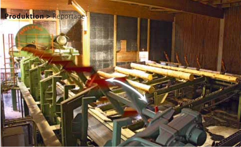
Die drehenden Auswerfer befördern die Stämme ohne Zwischenstopp weiter
