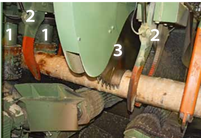
Die Stachelwalzen (1) und Zangen (2) halten den Stamm fest, während die Kreissäge (3) mit 2 m Durchmesser kappt
