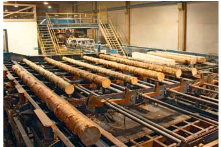
Bunt gemischt gelangt das Holz zur EWD-Sägelinie: Stark- und Schwachholz sowie Modeln aus dem Rundlauf wechseln sich ab
