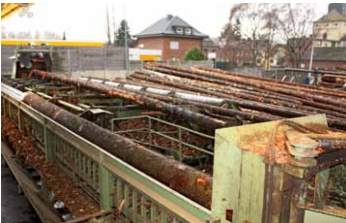
Langholz bis 21 m kommt bei Eigelshoven zum Ausformen auf den Holtec-Rundholzplatz
