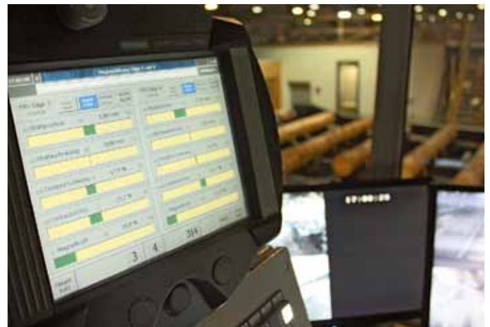
Die Messung gibt alles preis: Am Bildschirm sieht der Bandsägenführer ständig die Abweichungen, welche die Flying-Bandsaw korrigieren muss
