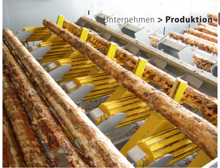
Ausrichteinheit mit Mitnehmerrad und nachgeschaltetem Stufenzuteiler
