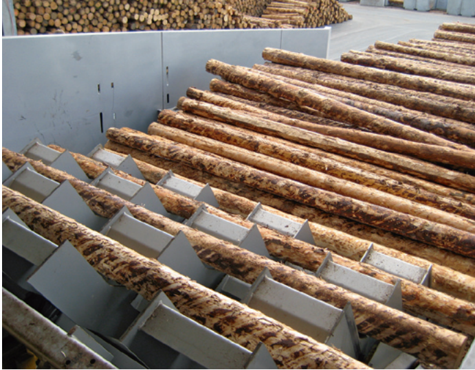
Stufenschieber mit doppelwirkendem Arbeitsprinzip
