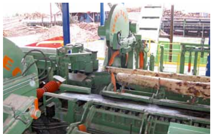
Holtec-Kreissäge – Blick auf eine der beiden Kapplines
