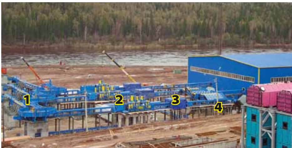
Fast drei identische Aufgaben zu den Sägelinien: 1 Drehvorrichtung, 2 Entbindungsmaschine, 3 Metallsuchgerät, 4 Ausricht- und Vereinzelungsquerförderer
