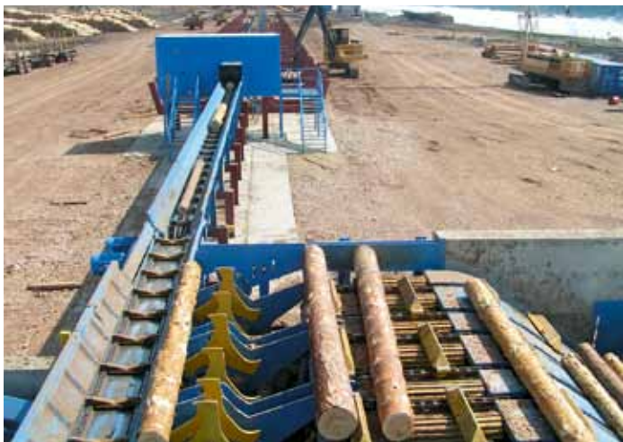
Aufgabe der Stämme am Rundholzplatz (re.), Vereinzelung und Längstransport durch die Vermessung (li.)
