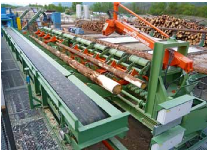
Neuer Wurzelreduzierer stammt von Baljer & Zembrod: Stämme von 2,2 bis 12 m Länge werden bearbeitet
