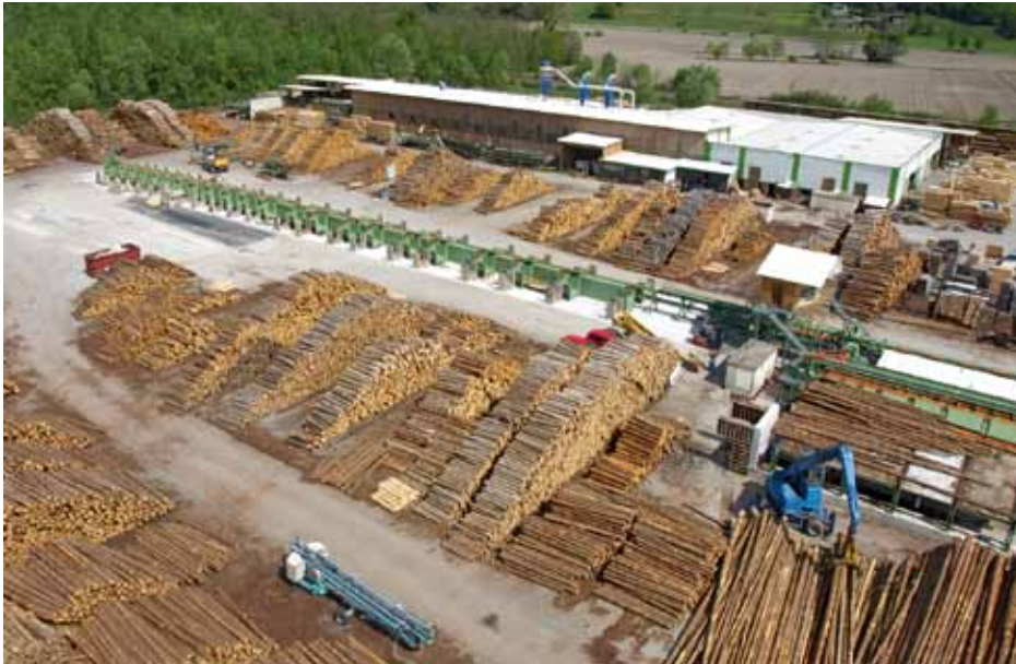
Neue Rundholzplatz-Anlage von Holtec: Sortiert wird in 42 Boxen
