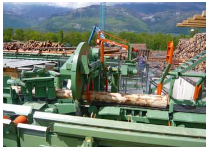
Rundholzkapplinie mit speziellem Beschickungs- und Anschlagssystem für eine hohe Positionier- und Zentriergenauigkeit
