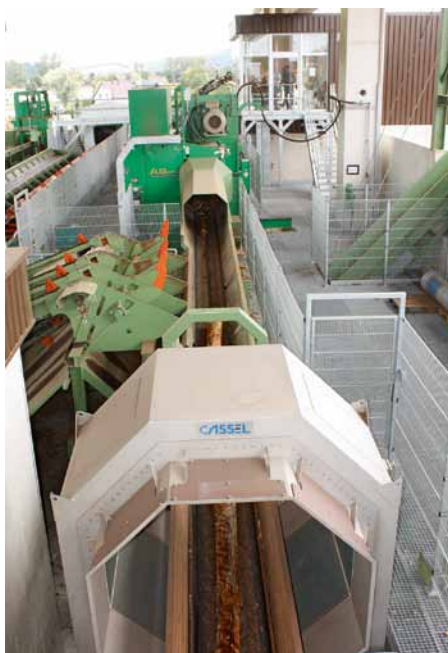
Schnurgerade verläuft die Linie für Kurzholz durch Entrinder und Metallsuchergerät
