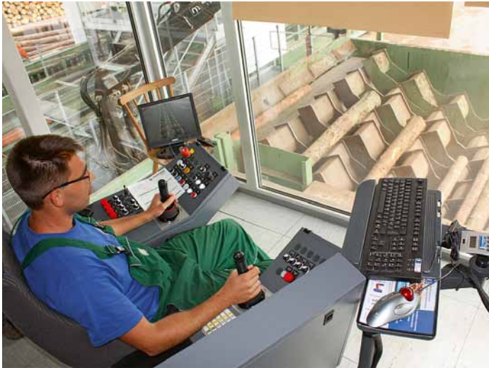
Alles im Griff und im Blick: Ein Mitarbeiter bedient und überwacht abwechselnd die Kurz- und Langholzanlage
