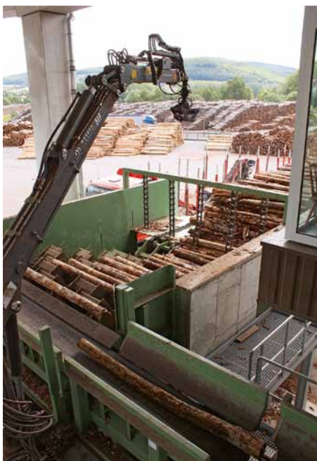
Aufgabestation für Kurzholz , die Vereinzelung erfolgt über den bewährten Stufenschieber
