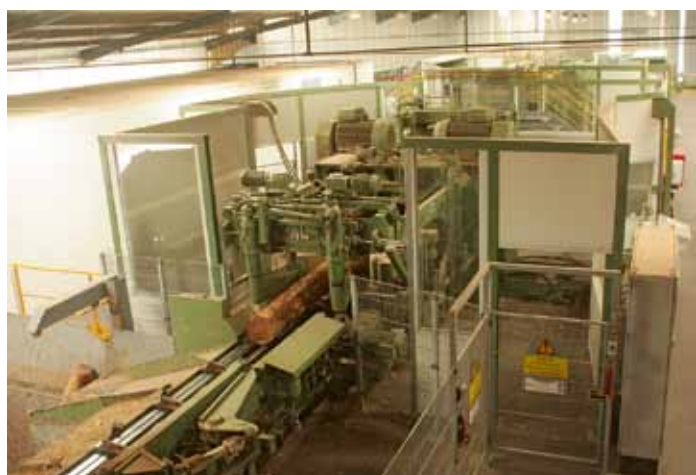
120.000 fm/J lautet das Ziel, das mit der neuen Profilerlinie von Linck erreicht werden soll
