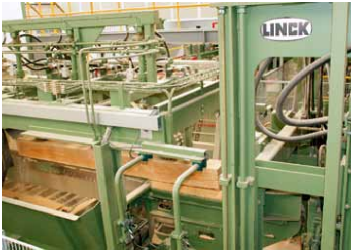
Hinter der CSMK 285-A1/B1 werden die Seitenbretter separiert und online zur Stapelung transportiert
