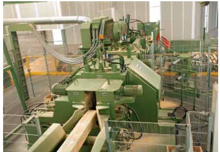
Zu guter Letzt wird das Kantholz mit einer Horizontalkreissäge HKM 360 (bei Bedarf) sowie einer CSMK 285-A1 aufgetrennt
