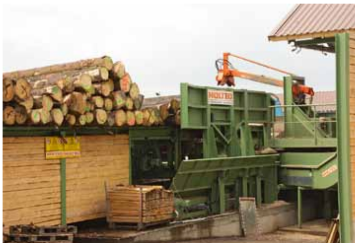
Rundholzplatz von Holtec: Das bis zu 22 m lange Rundholz wird per Kran auf einen Vorratsquerförderer aufgegeben
