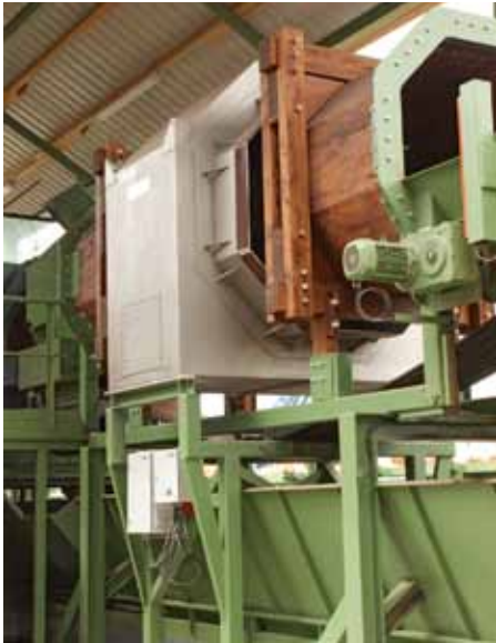
Das Metallsuchgerät wurde direkt an die Entrindung gekoppelt
