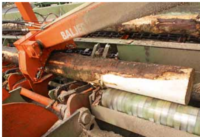
Ein Reduzierer von Baljer & Zembrod fräst am Stockende die Wurzelanläufe weg
