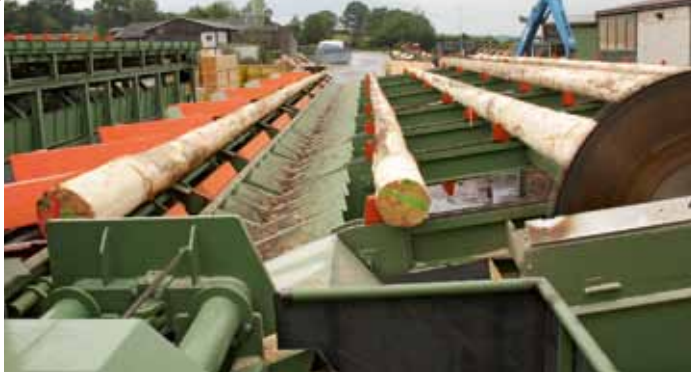
Langholz kommt von links aus der Vermessung, danach Zwischenpuffer mit Stirnkappung
