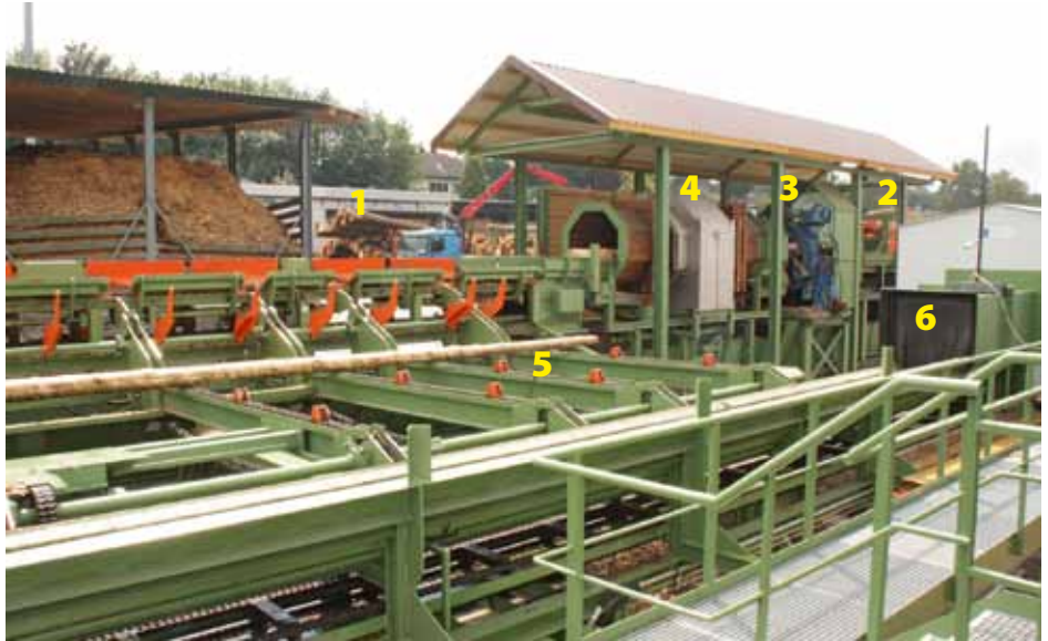
Übersicht Rundholzplatz bei Hüster: 1 Rundholzaufgabe mit Kran; 2 Wurzelreduzierer; 3 Entrindung; 4 Metallsuchgerät; 5 Puffer-Querförderer; 6 Einzug zur 3D-Vermessung
