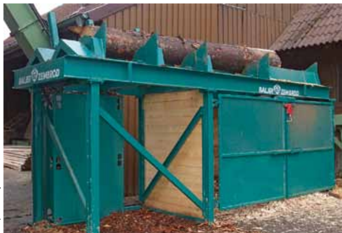
Der neue Wurzelreduzierer WRT-SSB von Baljer & Zembrod benötigt nur eine geringe Anschlussleistung von 21 kW in der Standardausführung
