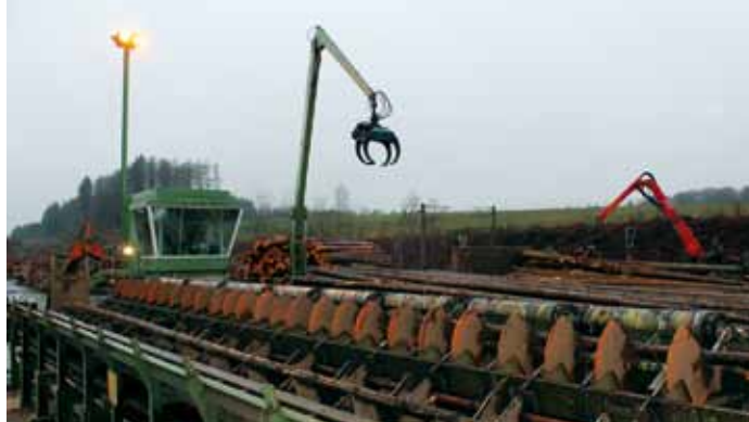
Holzaufgabe: Abgeladen vom Lkw werden die Hölzer quergefördert, vereinzelnd und vermessen
