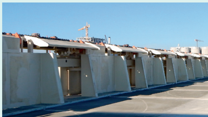
Blick auf die Abschnittsortierung bei Schweighofer in Reci/RO: Die Anlage verfügt über zwei Beschickungen mit Chainless-System und 96 Sortierboxen
