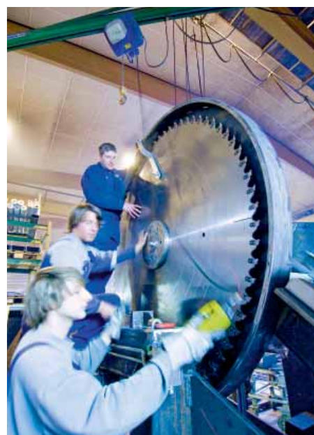
Kappkreissäge vor dem Probelauf bei Holtec
