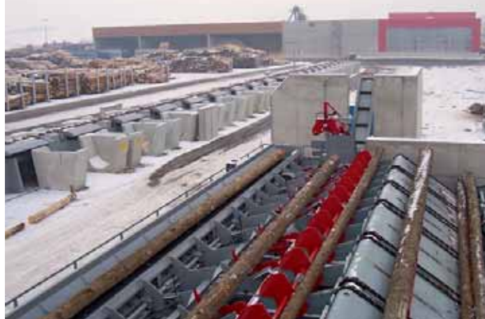
Vereinzelung und Wurzelreduzierung (im Vordergrund), hinten links die Sortierlinie mit 50 Betonboxen
