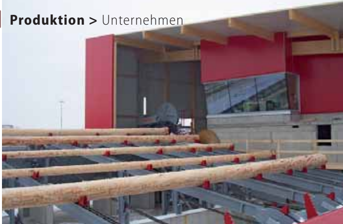
Die ersten Rundholzstämmе auf der Querübergabe mit Anschnittsäge bei Ladenburger in Kerkingen
