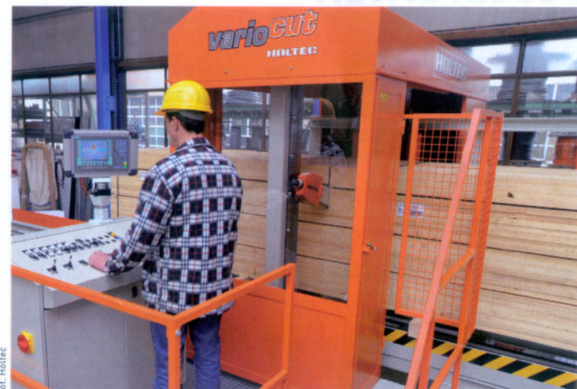
Stacja do kapowania Vario-Cut może być wyposażona w elektroniczną kontrolę cięcia, pomiar długości i liczby wykonanych cięć oraz indywidualne programowanie długości pakietów.
