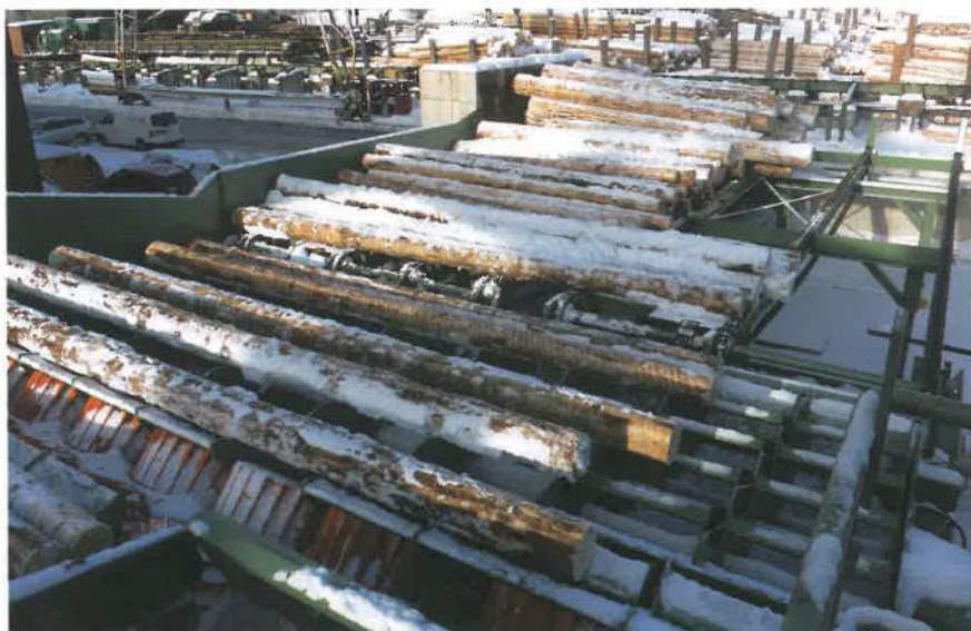
W firmie I. van Roje&Sohn zastosowano podajnik rolkowy firmy Holtec, na który odcinki drewna podawane są w dopasowanym rytmie zarówno z nowych, jak i dotychczas istniejących stołów podawczych. fot. Holtec
